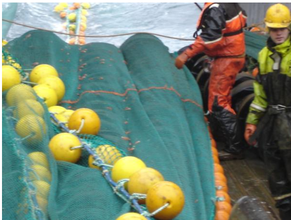
Figur 12 . Reke kledd i sidepanelet til trålen.
